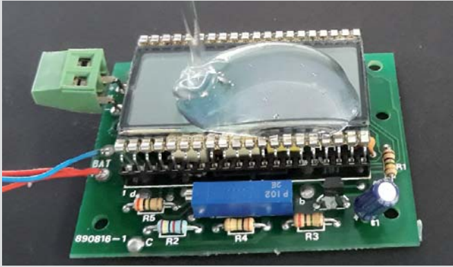
Aufbringung des Thermomanagement-PCM-Compounds im Hotmelt-Prozess auf eine Elektronik. Foto: ESDA/Axiotherm GmbH
