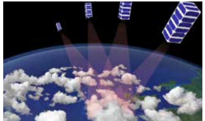
In CloudCT wird das Sonnenlicht genutzt, um einen Blick in das Innere der Wolken zu werfen. 10 Kleinst-Satelliten empfangen aus verschiedenen Blickrichtungen das Streulicht und können so das Wolkeninnere mit Hilfe ausgefeilter Software aus den Kamerabildern rekonstruieren. Fotos: Zentrum für Telematik
